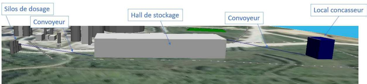
Figure 4 : Vue 3D de la zone de concassage sous CadnaA
